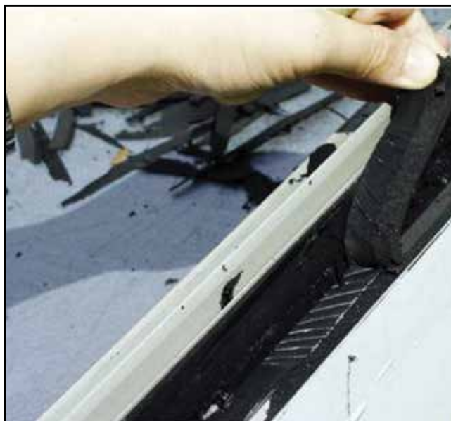
МАЛЮНОК 19 Хороша адгезія, позитивний тест
