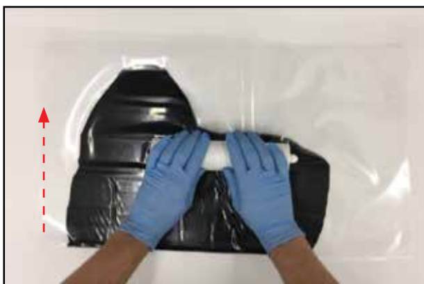
МАЛЮНОК 10 Натисніть на смужку в напрямку, перпендикулярному до вигину
