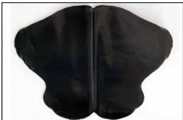
МАЛЮНОК 11 Розгорніть плівку - Позитивний тест = ідеальне змішування
