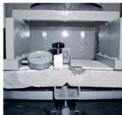
Випробування на перекриття статичної тріщини відповідно до EN 1062-7 (метод А)
