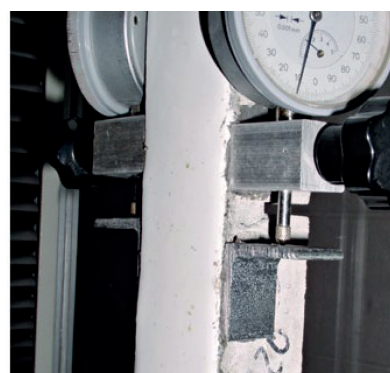
Динамічне випробування перекриття тріщин відповідно до EN 1062-7 (метод В)
