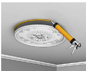
Приклеювання ліпних елементів до внутрішніх стін та стелі.
