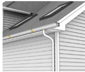
Склеювання водостічних труб.
