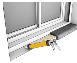
Приклеювання внутрішніх підвіконь.
