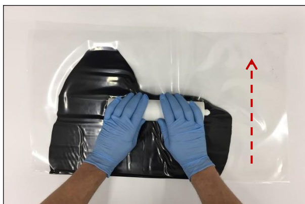
Малюнок 5: Притискайте суміш тільки в напрямку перпендикулярному до згину
