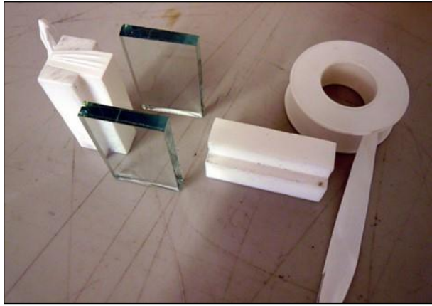
Малюнок 15: Дистанція, е-PTFE стрічка (стрічка є обов'язковою для 1-компонентних клеїв) та елементи поверхні (наприклад скло)
