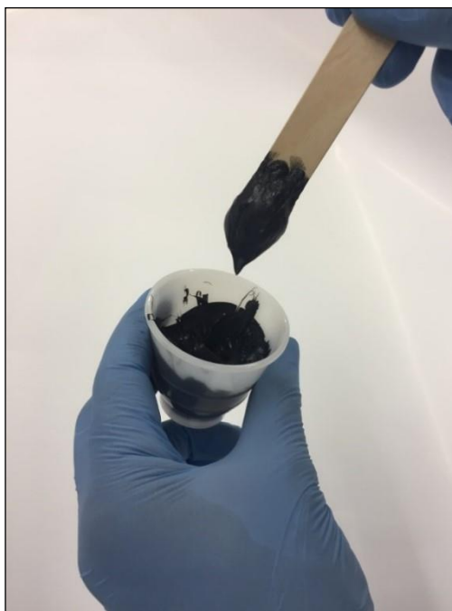
Малюнок 9: Матеріал демонструє поведінку, подібну до каучуку: час схоплення досягнутий
